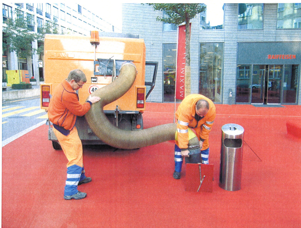
provisorisch umgerüstete Putzmaschine
