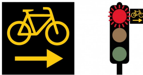
Signalisation für Rechtsabbiegen bei Rot(Quelle: www.mobilservice.ch)
